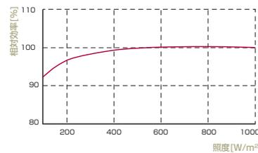
STC条件(25°C, 1000W/m<sup>2</sup>, AM1.5 Gスペクトル)から照度が下がる場合の太陽電池モジュールの性能
